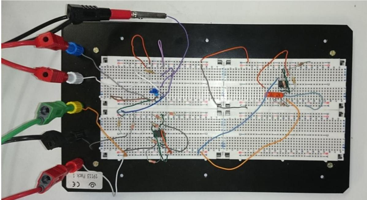
Circuit maître, montage suiveur et circuit esclave
